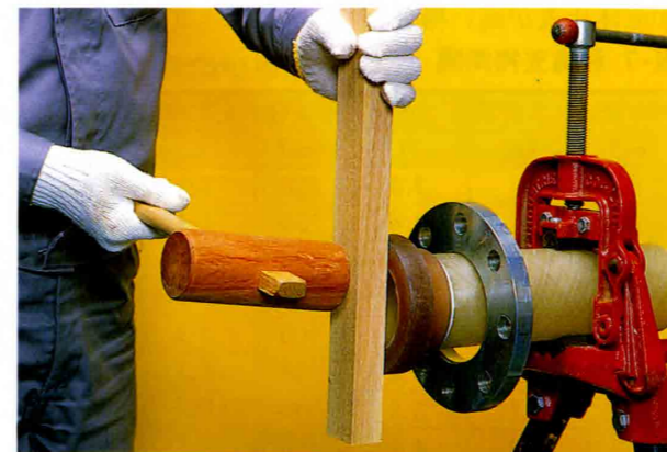
当て木を用いてコアリング打込み
