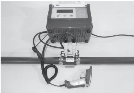
図7 熱線融着継手の融着状況
