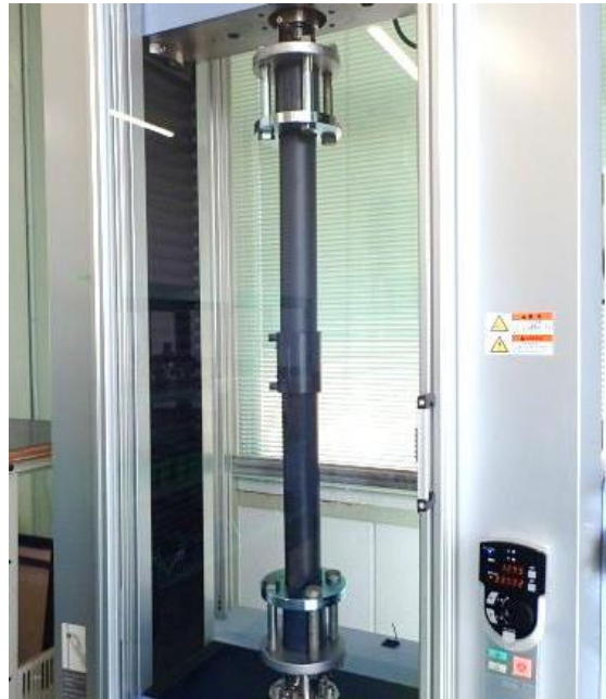
図 4-3 : 引張試験状況
