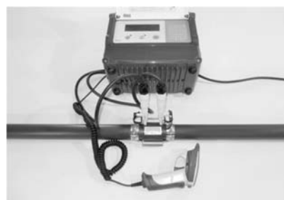
図8 熱線融着継手の融着状況
